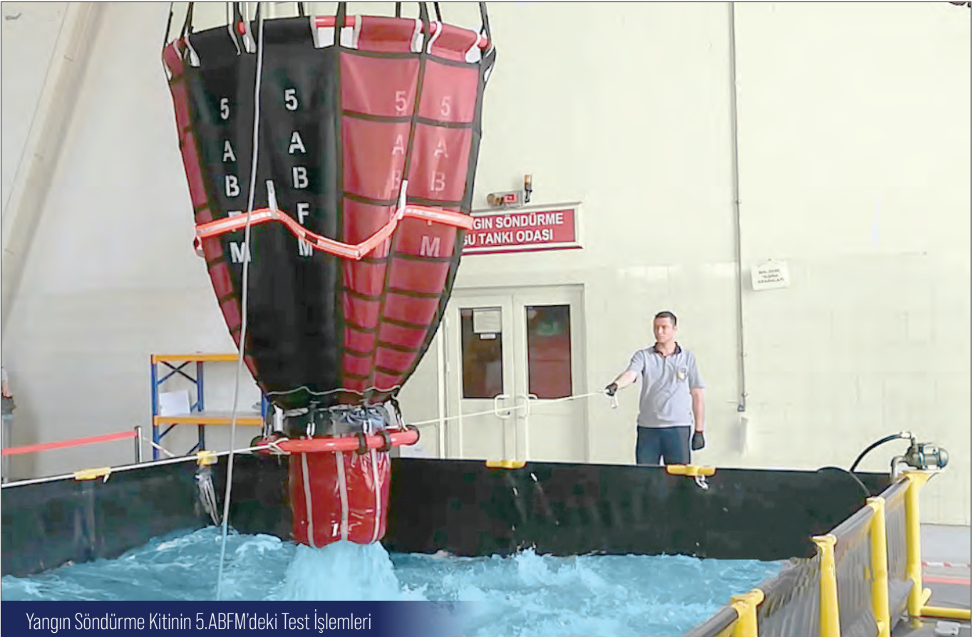
Yangın Söndürme Kitinin helikopterle su alınıp boşaltılarak test edilmesi
